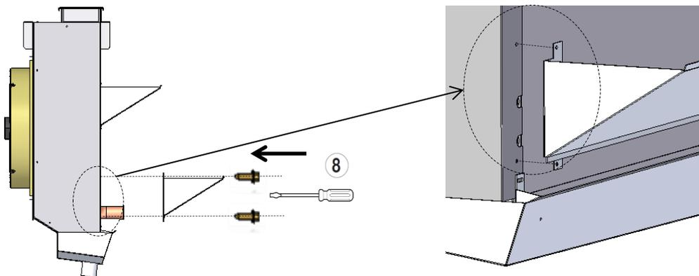
8. 将下挡板安装在工作位置，拧紧固定螺钉
