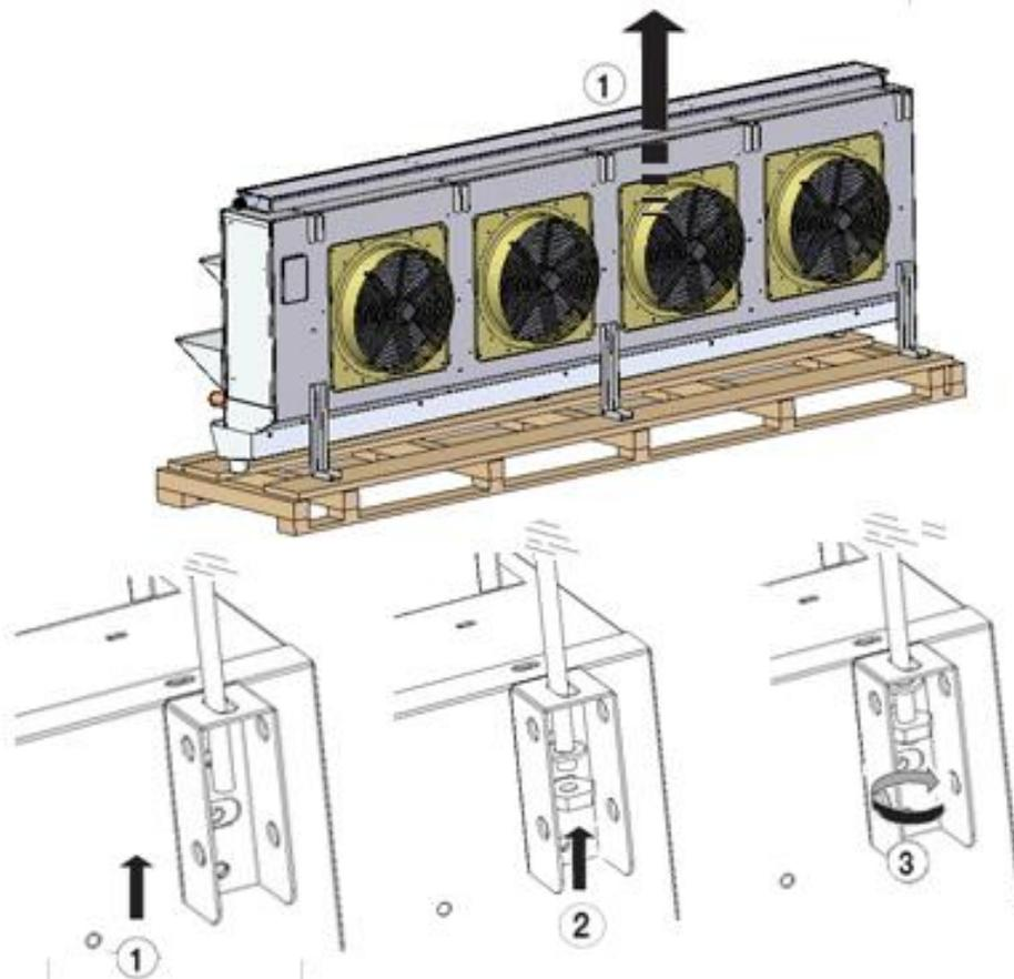
1~3. 将冷风机吊装到库顶并使用螺栓固定
