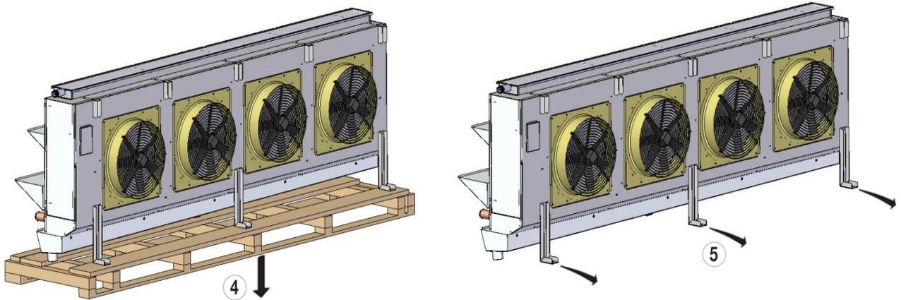
4~5. 移除木底托，移除正面支脚（移除支脚后，请将固定螺栓重新安装好，避免螺栓孔可能渗水）
